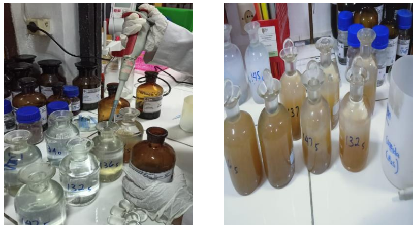
Gambar 6. Hasil Pengujian ketika penambahan MnSO_4 dan alkali dilakukan
