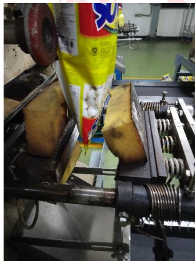
Kondisi busa sealer yang aus dan sudah menipis
