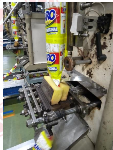
Kondisi busa sealer yang sudah diganti
