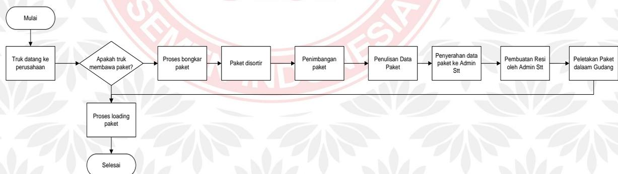
Gambar 2.1 *Flowchart* Proses Logistik pada PT LSJ
