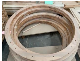
Gambar 4.6 Kayu Yang Sudah Dilubangi
