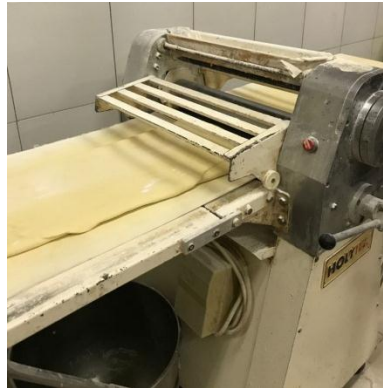
Gambar 4. 6 Proses Penggilingan Adonan Menggunakan Alat Sheeter
