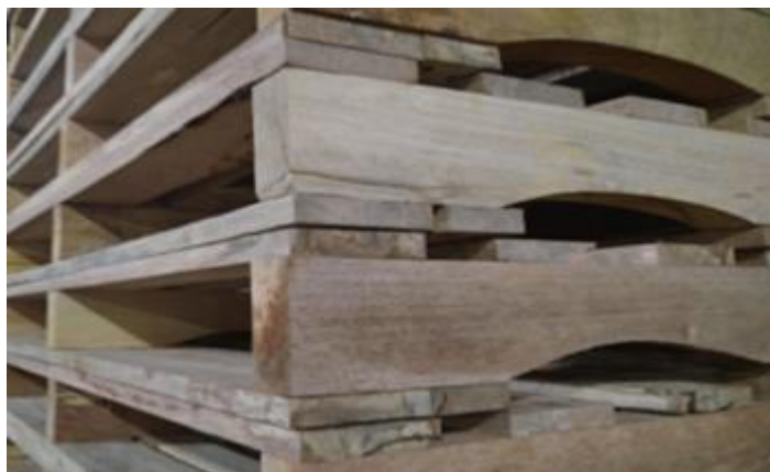
Gambar 4. 3 Keretakan pada kayu pallet
