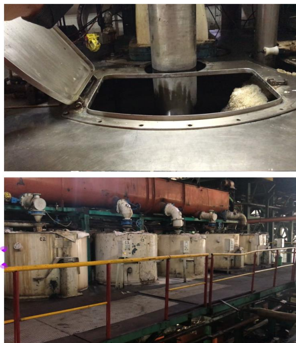
Gambar 4.25 Stasiun Puteran (atas : puteran, bawah : cascade crystallizer )
