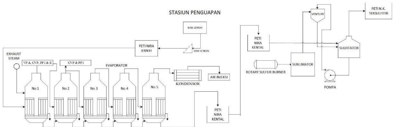
Gambar 4.21 Alur proses penguapan
