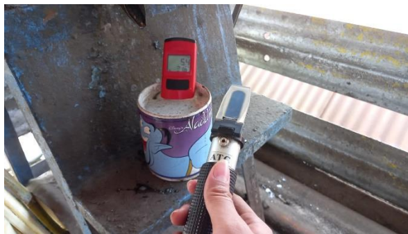
Gambar 4.7 Pengujian nilai Brix dan pH
