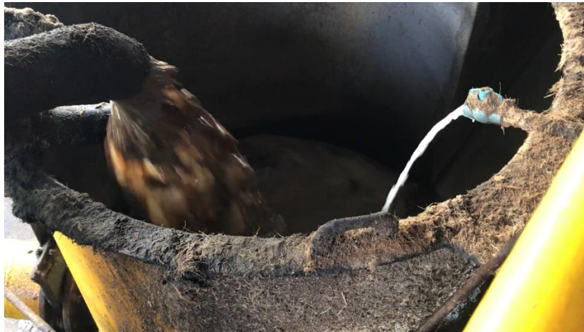
Gambar 4.13 Penambahan Lime Milk pada nira mentah
