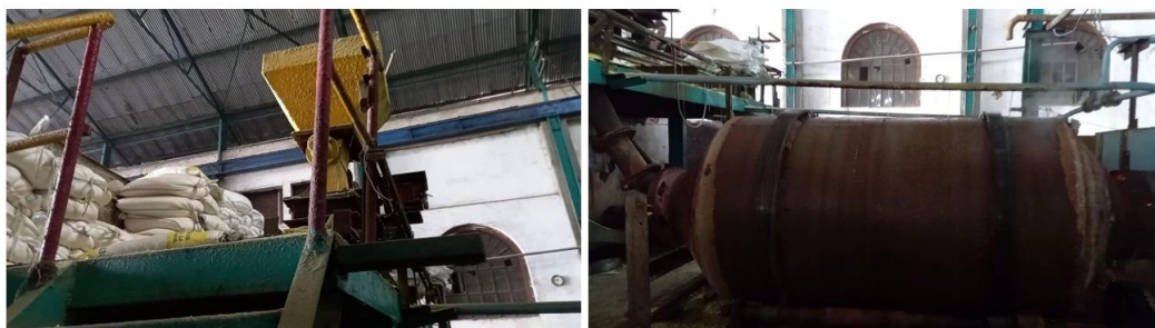
Gambar 4.19 (kiri) corong untuk memasukkan belerang, (kanan) rotary burner untuk pembakar belerang
