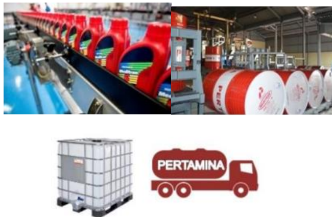
Gambar 2.7 Kemasan lithos (0,8 liter, 1 liter, 4 liter, 5 liter dan 10 liter), kemasan drum (200 litel dan 220 liter), kemasan curah ( IBC 1000 liter dan tanker truck ).
