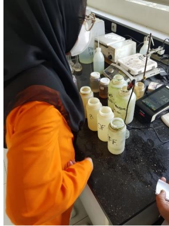
Gambar 11. Pengukuran pH Sampel dengan pH Meter Sumber: Dokumentasi Pribadi (2022)
