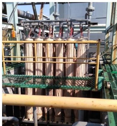
Gambar 13. Proses Pembersihan Membran Sumber: Dokumentasi Pribadi (2022)
