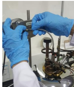
Gambar 4.4 Pemasangan stirrer pada PMMC unit
