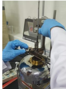
Gambar 4.3 Pemasangan test cup pada PMMC unit
