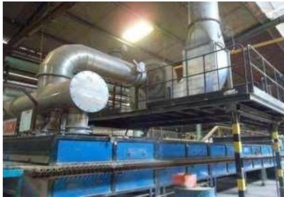
**Gambar 3.10** Prekiln dan Smoke fan
