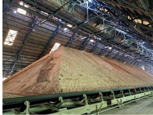
Gambar 4.8 Pile Hasil Crusher di Storage
