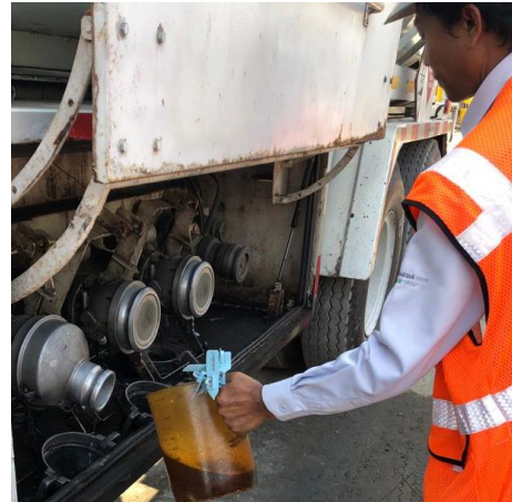
Gambar 4.11 Pengambilan Sampel Solar
