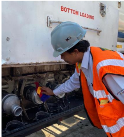
Gambar 4.10 Pembukaan Tutup Solar
