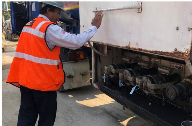
Gambar 4.5 Pembukaan Segel Tutup Solar
