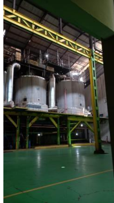
Gambar 3.5 Evaporator pada Stasiun Penguapan
