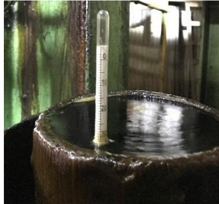
Gambar 3.6 Pengecekan Nilai Bom Meter Pada Sampel Nira
